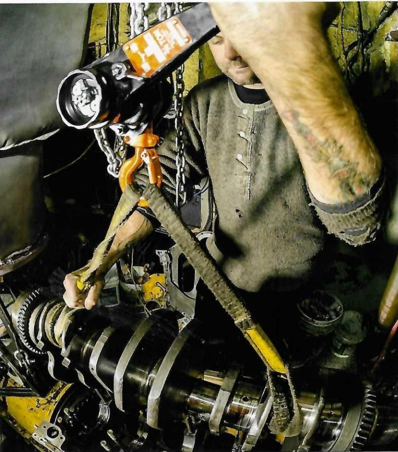
Les nouveaux palans à chaînes électriques de la série JEH de JET sont conçus pour les applications industrielles et commerciales robustes. Ces palans à chaînes durables sont équipés d'une chaîne de charge de qualité 80 et d'une protection contre les surcharges standard. Ils sont disponibles en configurations monophasée et triphasée et peuvent être modifiés pour des hauteurs de levage personnalisées afin de répondre à vos besoins.
